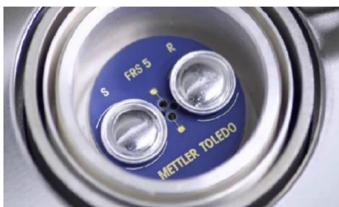
Slika 13. Mjerno osjetilo DSC uređaja
