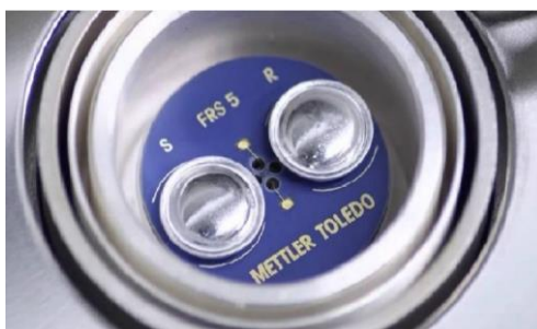
Slika 13. Mjerno osjetilo DSC uređaja
