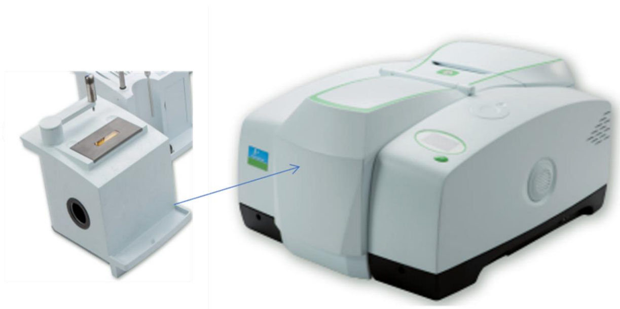
Slika 14. Perkin-Elmer Spectrum One FT-IR spektrometar s dodatkom za HATR 16
