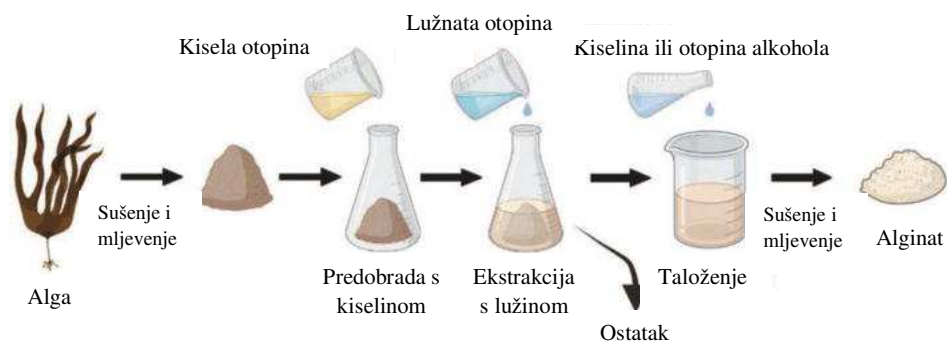
Slika 6. Klasični postupak ekstrakcije alginata iz smeđih algi 16
