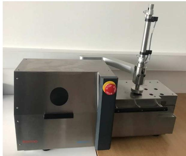
**Slika 10.** Dvopužni laboratorijski ekstruder HAAKE MiniLab 3
