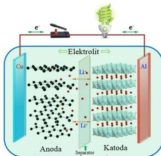
Slika 7. Shema konfiguracije sekundarnih litij-ionskih baterija<sup>21</sup>
