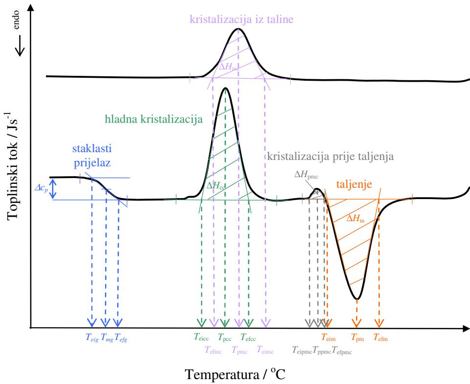
**Slika 11.** Određivanje značajki krivulje diferencijalne pretražne kalorimetrije<sup>28</sup>
