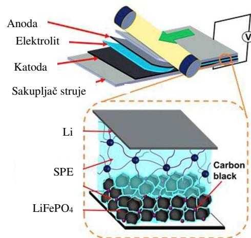
Slika 9. Prikaz krutog polimernog elektrolita u litijevoj bateriji<sup>25</sup>
