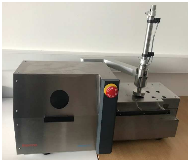
Slika 10. Dvopužni laboratorijski ekstruder HAAKE MiniLab 3
