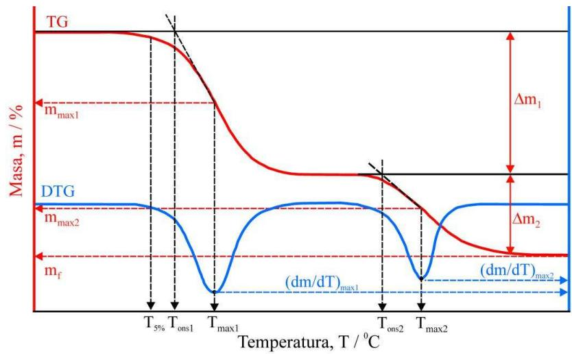
Slika 12. Određivanje značajki termogravimetrijskih krivulja<sup>28</sup>
