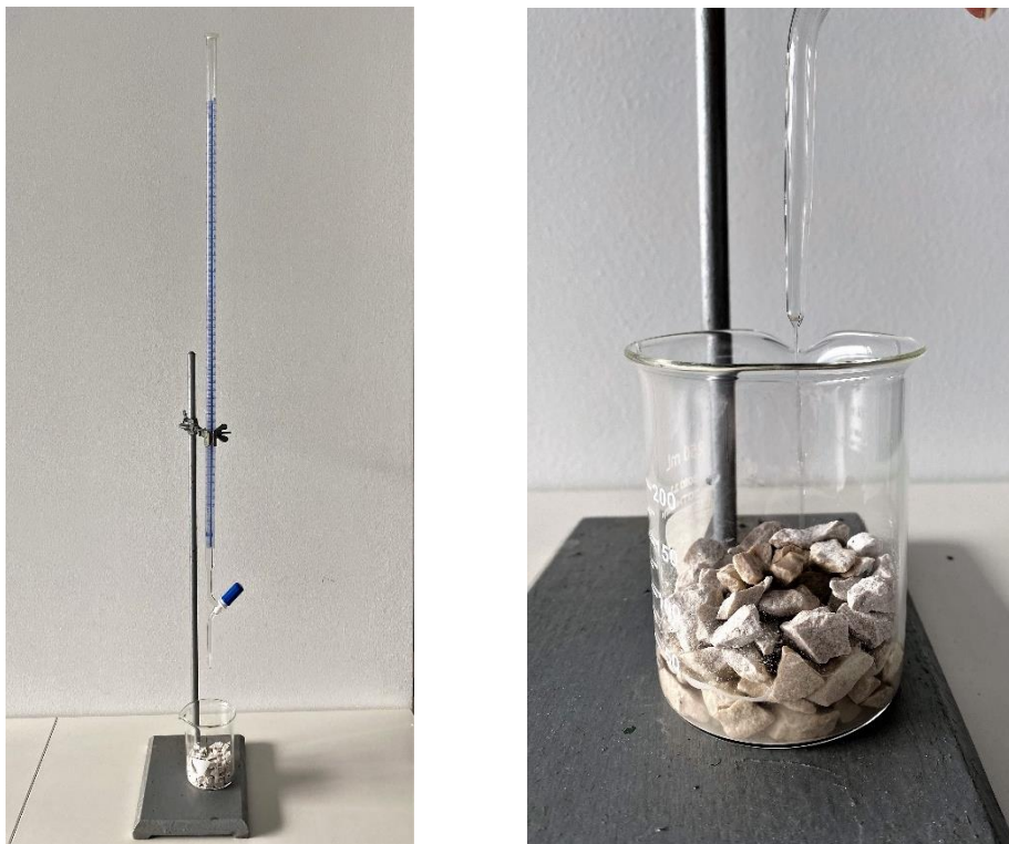
Slika 16. Aparatura za određivanje poroznosti metodom zasićenja.
