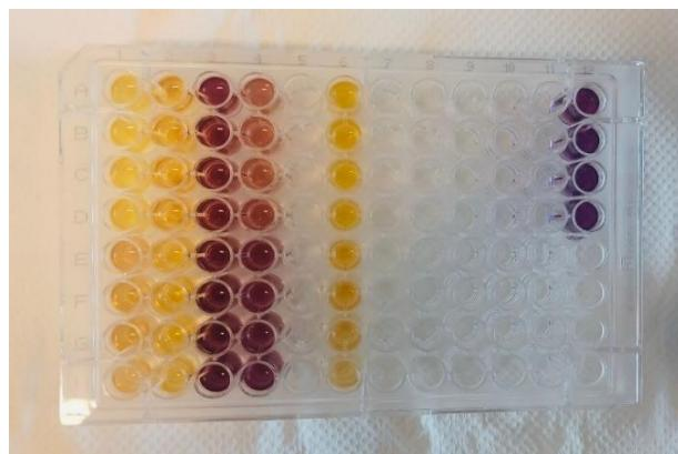
Slika 9. Mikrotitarska pločica korištena kod DPPH metode
