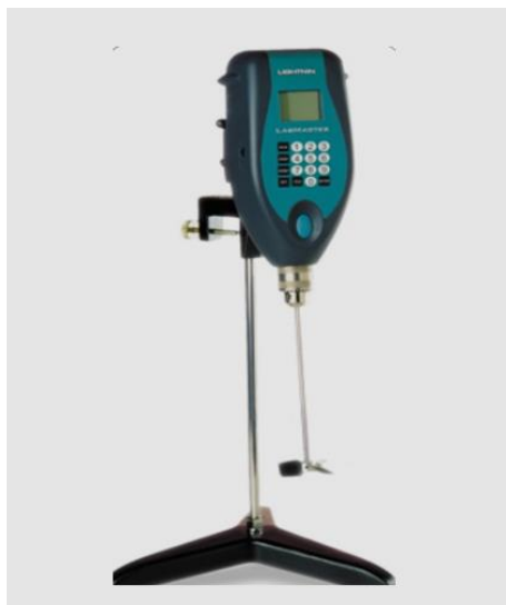
Slika 13. Miješalica tipa Lightning Labmaster LIU10F 57 .
