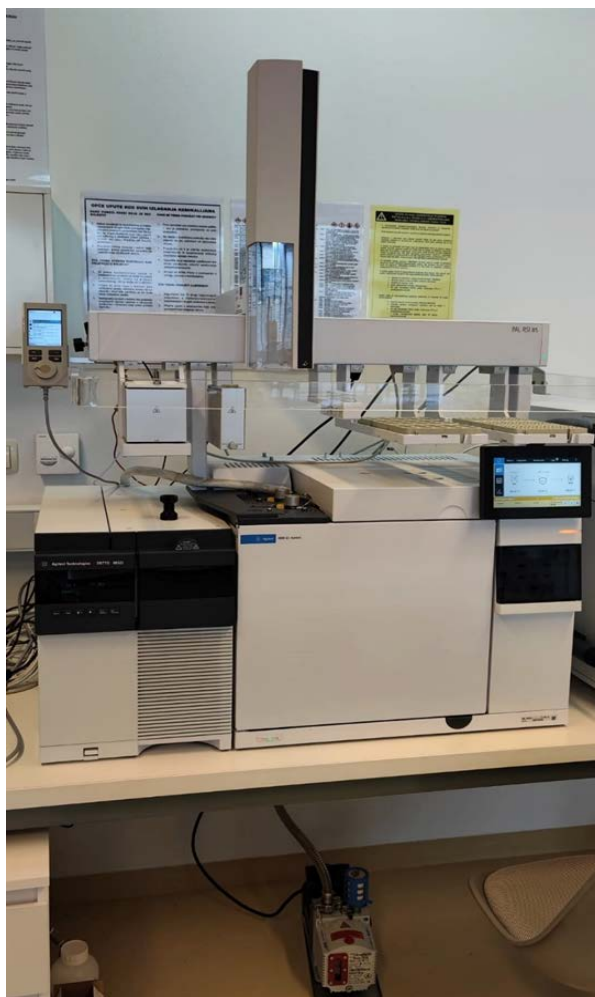
Slika 6. Korišteni vezani sustav plinska kromatografija-spektrometrija masa (GC-MS).
