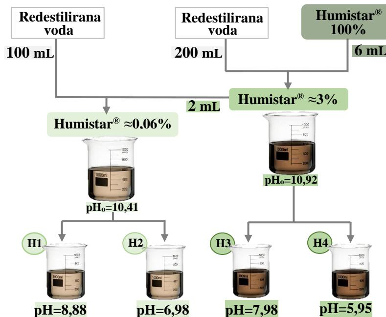
**Slika 2.4.** Shematski prikaz postupka pripreme otopine huminske kiseline.
