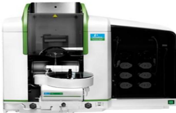
**Slika 2.8.** Uredaj za atomsku apsorpcijsku spektrometriju Perkin Elmer PinAAcle 900F AAS.
