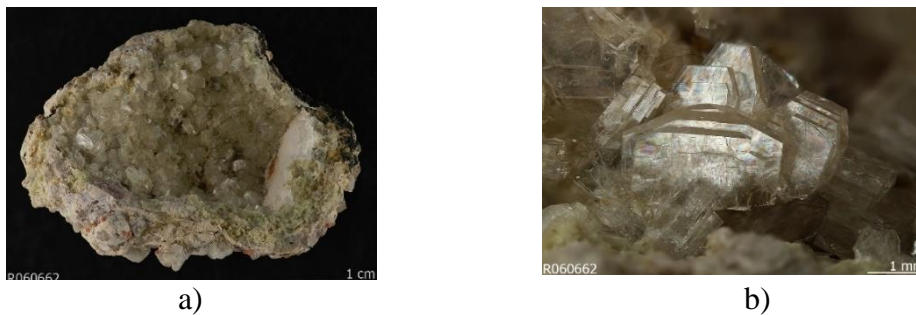
Slika 1.5. Prirodni zeolit klinoptilolit: a) u stvarnom mjerilu, b) u uvećanom mjerilu. 29
