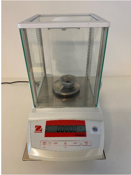
1.korak: Vaganje komponenata na analitičkoj vagi
