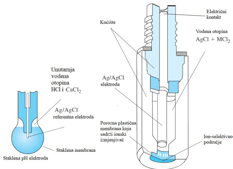
Slika 2. Usporedba staklene pH elektrode i tekućinske membranske elektrode<sup>[11]</sup>
