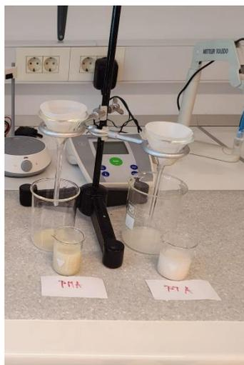
Slika 13. Filtracija nastalih taloga PMA i PTA
