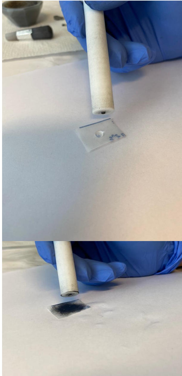
Slika 18. (a i b) Poliranje paste
