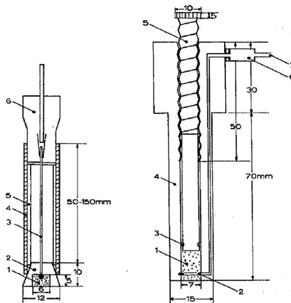
Slika 3. Konstrukcija elektrode<sup>[1]</sup>
