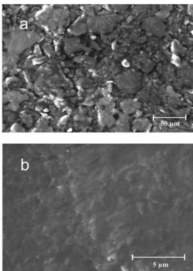
Slika 6. Usporedba površine CPE (a) i CILE (b)<sup>[22]</sup>
