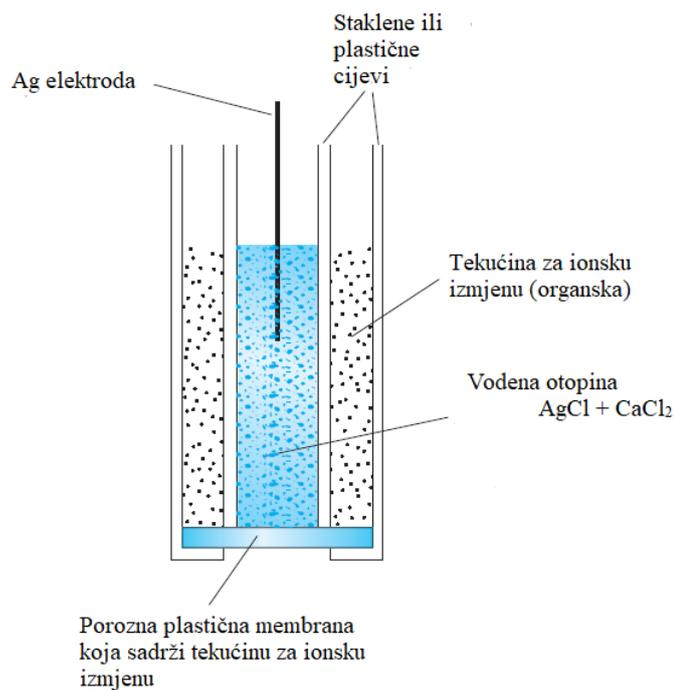
Slika 1. Tekućinska membranska elektroda za određivanje kalcijevog ( $\text{II}$ ) kationa<sup>[11]</sup>
