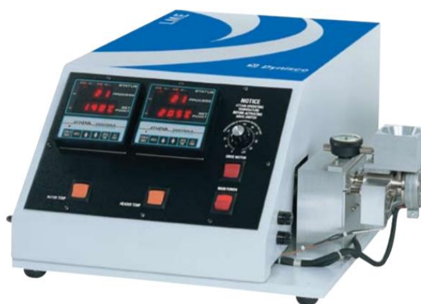
Slika 15. Jednpužni laboratorijski ekstruder DYNISCO LME 230 (QUALITEST, North America)
