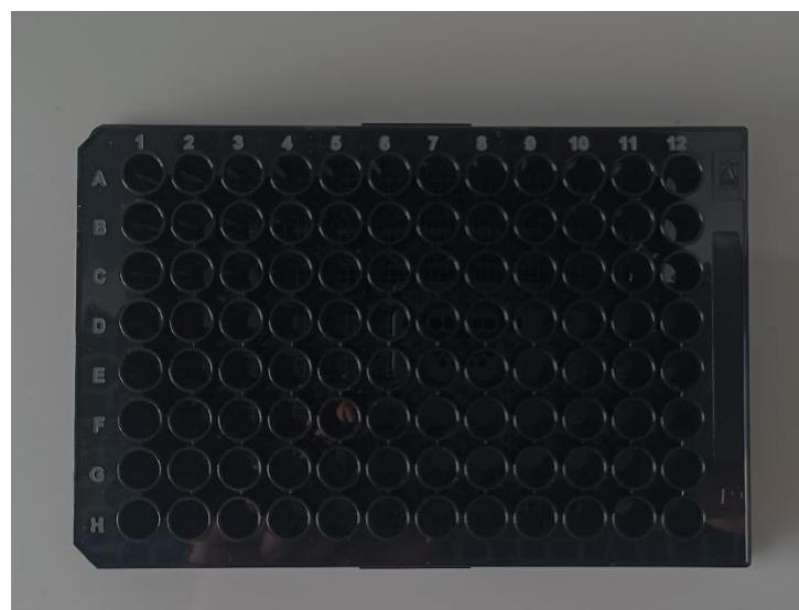
**Slika 6.** Izgled crne mikrotitarske pločice za mjerenje fluorescencije kod ORAC metode
