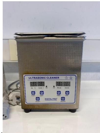
**Slika 3.** Ultrazvučna kupelj
