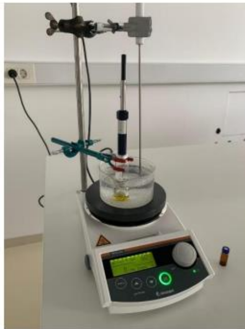
Slika 2.1 Aparatura za adsorpciju uzorka na sivo vlakno
