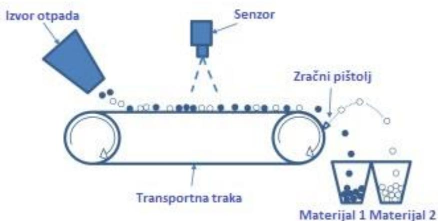
Slika 20. Princip rada NIR senzora<sup>35</sup>
