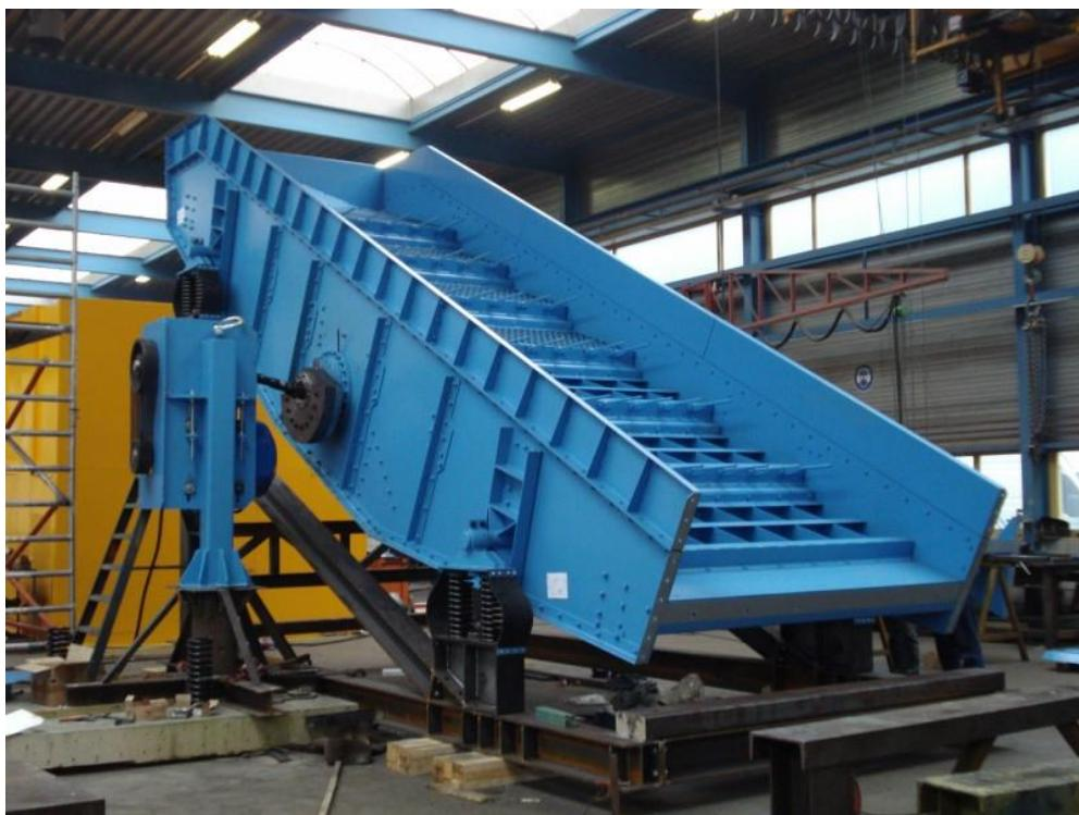
*Slika 16. Linearno vibracijsko sito<sup>29</sup>*
