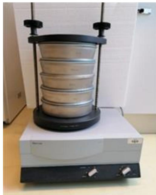
Slika 2.1. Laboratorijski uređaj za prosijavanje *Retsch AS200 basic'*
