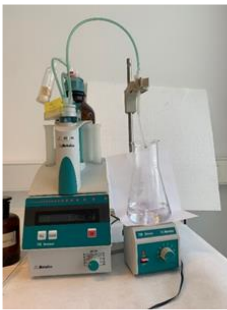
Slika 2.4. Promjena boje prilikom određivanja cinka kompleksometrijskom titracijom
