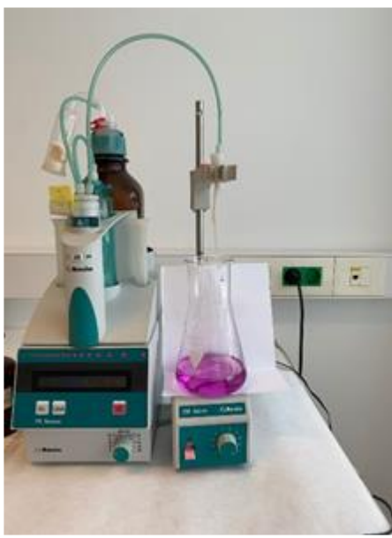
Slika 2.4. Promjena boje prilikom određivanja cinka kompleksometrijskom titracijom
