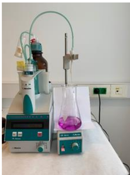
Slika 2.4. Promjena boje prilikom određivanja cinka kompleksometrijskom titracijom
