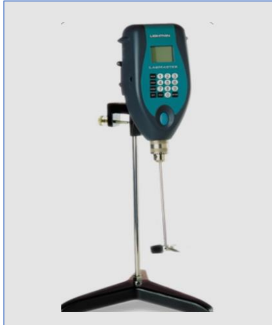
Slika 15. Miješalica tipa Lightning Labmaster LIU10F.
