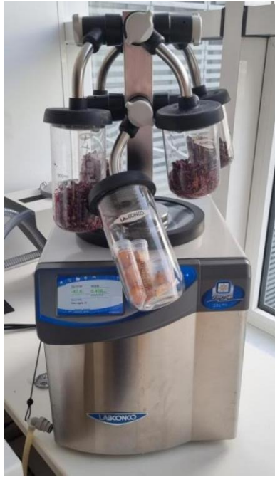
Slika 10. Uzorci na liofilizaciji
