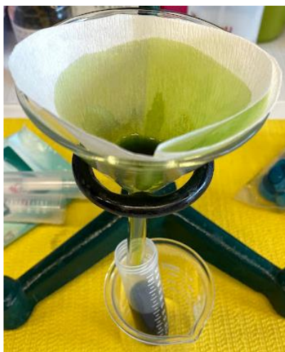
Slika 14. Filtracija uzorka nakon centrifugiranja
