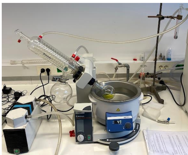
Slika 16. Uklanjanje etanola rotacionim vakuum uparivačem
