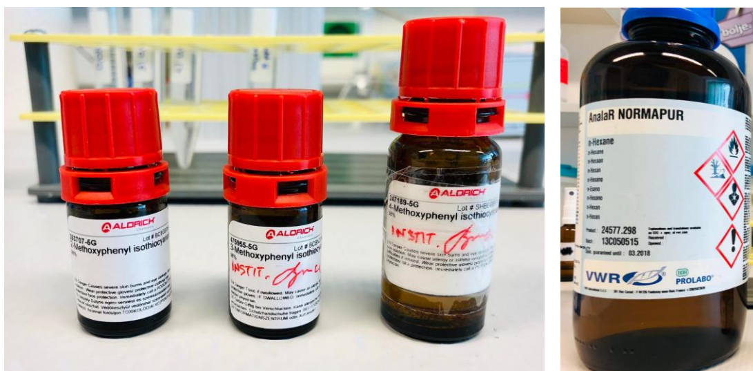
Slika 2.1. 2-, 3-, i 4-Metoksifenil-izotiocijanat te n-heksan korišteni za pripremu standardnih otopina
