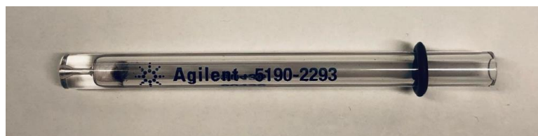
Slika 1.5. Stakleni umetak – liner
