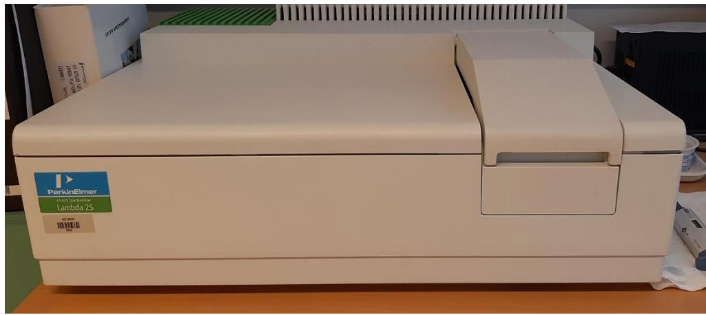
Slika 17. UV/VIS spektrofotometar Perkin Elmer Lambda 25
