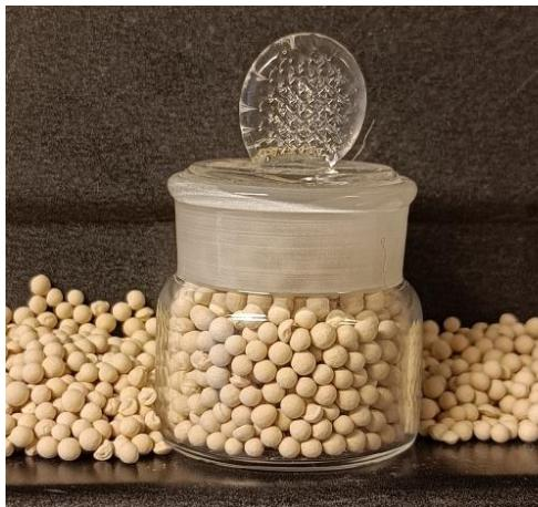
Slika 9. Sintetski zeolit NaX
