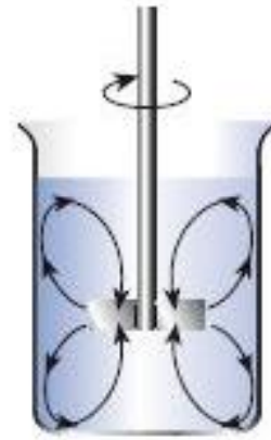
Slika 12. Aksijalno strujanje kapljevine 53 Slika 13. Radijalno strujanje kapljevine 54
