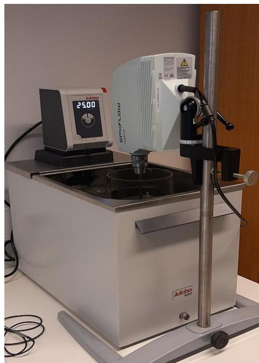
Slika 14. Aparatura za provedbu šaržne adsorpcije
