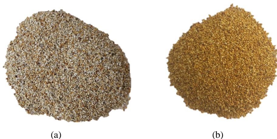
Slika 2.1. Usporedba (a) prirodnog i (b) Fe(III)-modificiranog zeolita.
