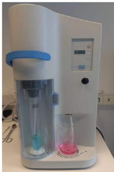
Slika 2.7 Uređaj za destilaciju
