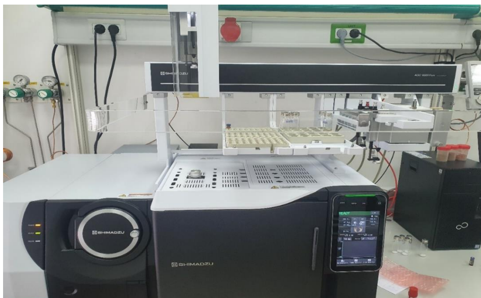
Slika 14. Vezani sustav plinska kromatografija-masena spektrometrija (GC-MS)
