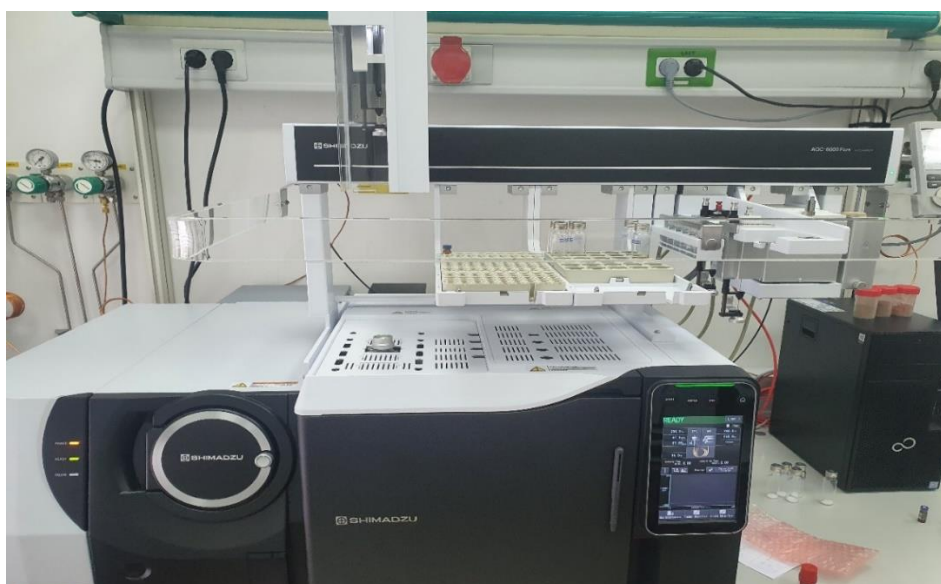
Slika 14. Vezani sustav plinska kromatografija-masena spektrometrija (GC-MS)
