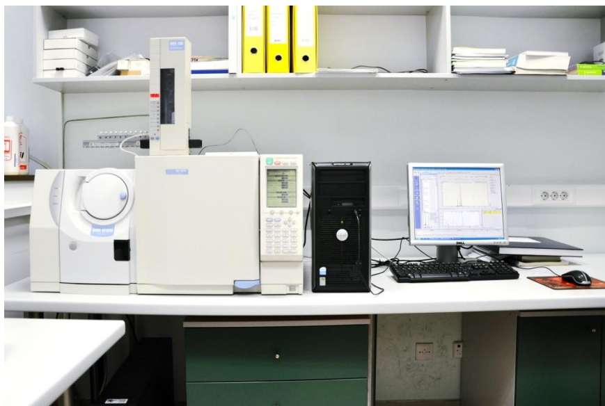
Slika 6. Plinski kromatograf sa spektrometrom masa; Shimadzu GCMS-QP2010
