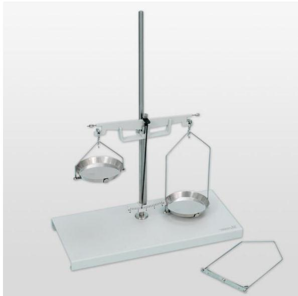
**Slika 11.** Hidrostatska vaga<sup>42</sup>
