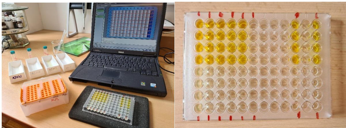
Slika 27. Multikanalna pločica s uzorcima za testiranje sposobnosti inhibicije AChE i BChE te višekanalni čitač mikrotitarskih pločica "Sunrise" (Tecan GmbH, Austria).
