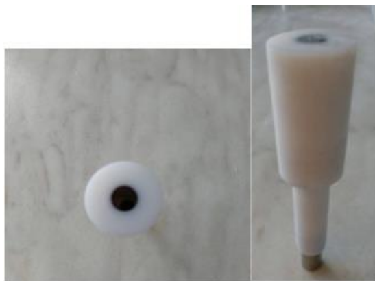
Slika 21. GCE – radna elektroda
