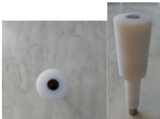
Slika 21. GCE – radna elektroda
