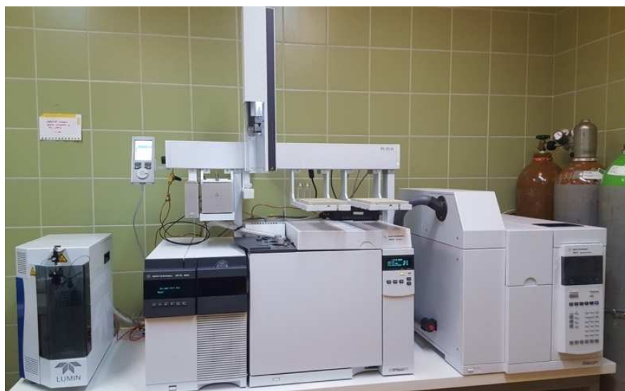
Slika 11. Spregnuta tehnika plinska kromatografija-spektrometrija masa (GC-MS)
