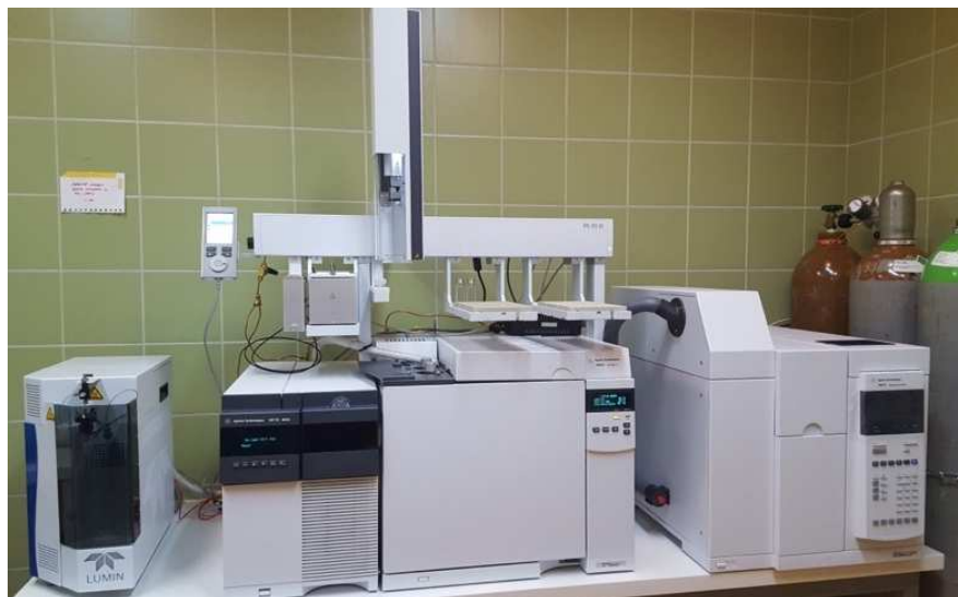
Slika 11. Spregnuta tehnika plinska kromatografija-spektrometrija masa (GC-MS)
