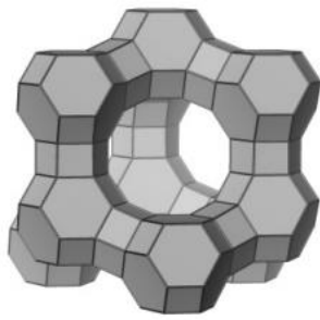
Slika 4. Strukturna mreža FAU zeolita 10
