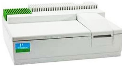
Slika 24. Spektrofotometar Perkin Elmer Lambda 25 UV/VIS 54
