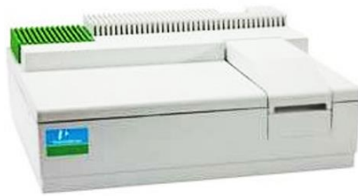
Slika 24. Spektrofotometar Perkin Elmer Lambda 25 UV/VIS 54
