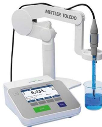
*Slika 2.3. pH metar tipa Mettler Toledo*
