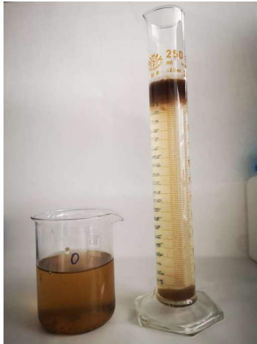
Slika 2.10. Prikaz taloženja početnog uzorka (procjedna voda) u menzuri
