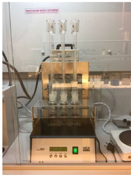
Slika 2.6. Kuhanje smjese u digestoru uz povrat
