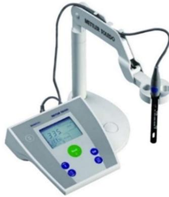
*Slika 2.4. Konduktometar tipa Mettler Toledo*
