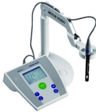
Slika 2.4. Konduktometar tipa Mettler Toledo
