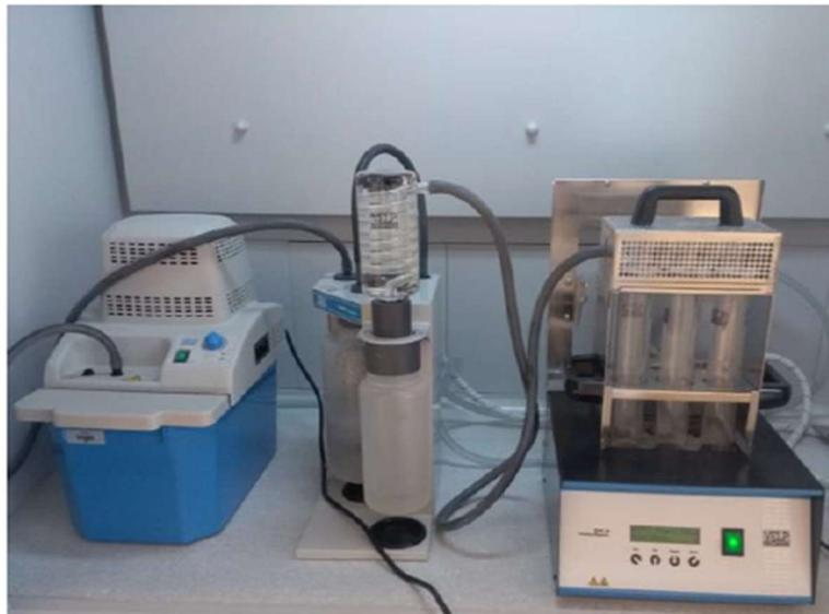
*Slika 2.7. Uređaj za digestiju uzorka*
