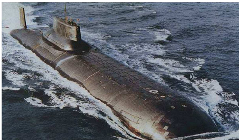
Slika 1.7. Primjeri primjene legura titanija u brodogradnji, podmornica s trupom od legure titanija 15
