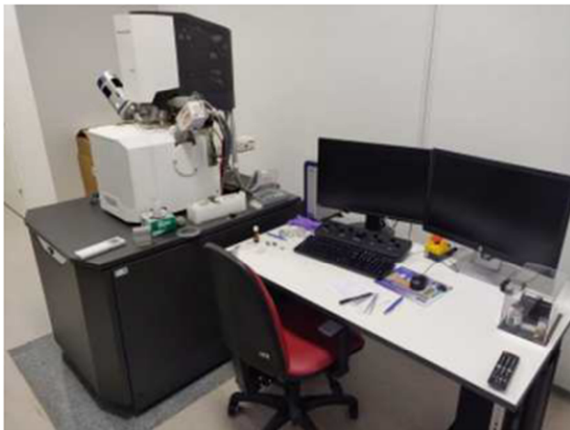
Slika 2.6. Pretražni elektronski mikroskop Quattro ESEM firme Thermo Fisher Scientific
