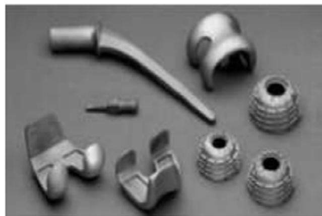
**Slika 1.11.** Ortopedska pomagala – dijelovi umjetnog kuka izrađeni od legura titanija<sup>15</sup>
