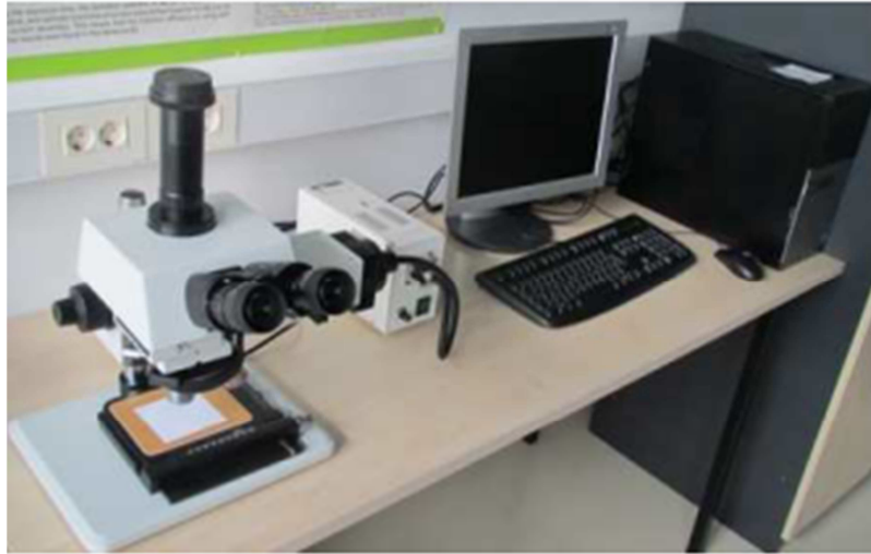
Slika 2.5. Optički mikroskop MXFMS-BD, Ningbo Sunny Instruments co.
