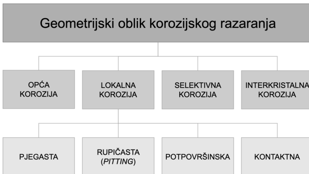
Slika 3. Klasifikacija korozije prema geometrijskom obliku korozijskog razaranja. 7
