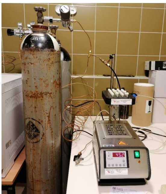
Slika 2.10. Uređaj za uparavanje u struji dušika
