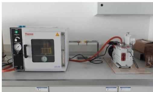
Slika 16. Vakuum sušionik
