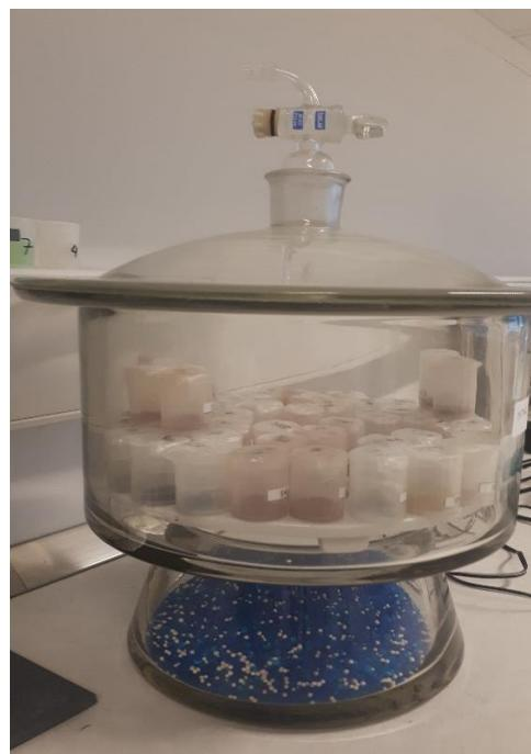
*Slika 21.* Uzorci spremljeni u eksikatoru
