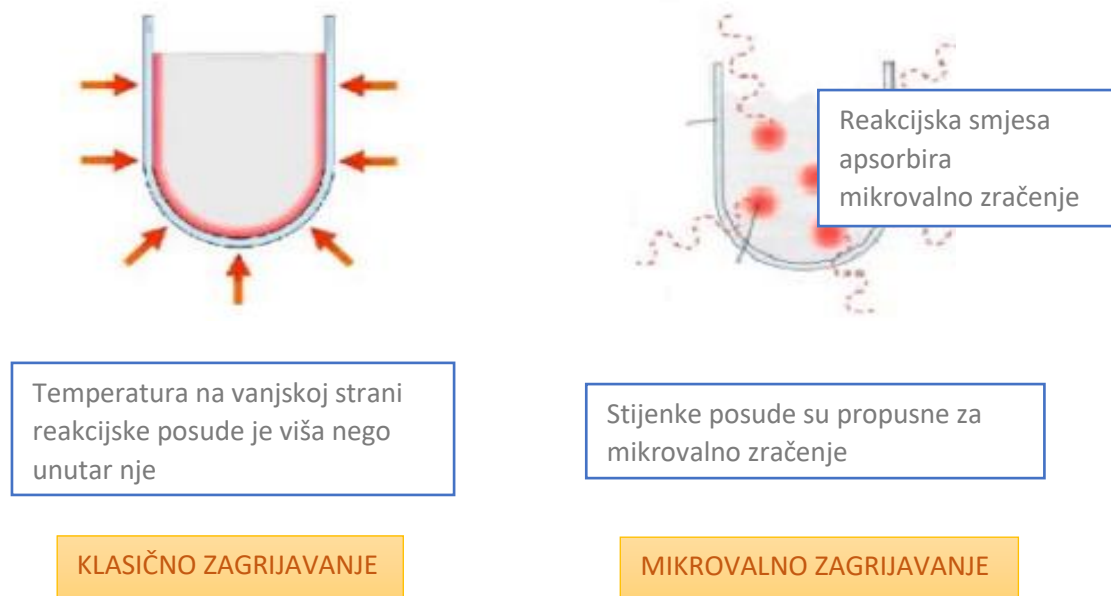
Slika 9. Usporedba klasičnog i mikrovalnog zagrijavanja 13
