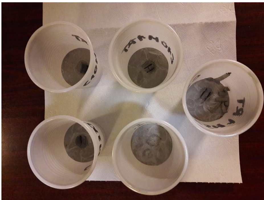
Slika 7. Uzorci cementne paste s različitim dodatkom MgO.
