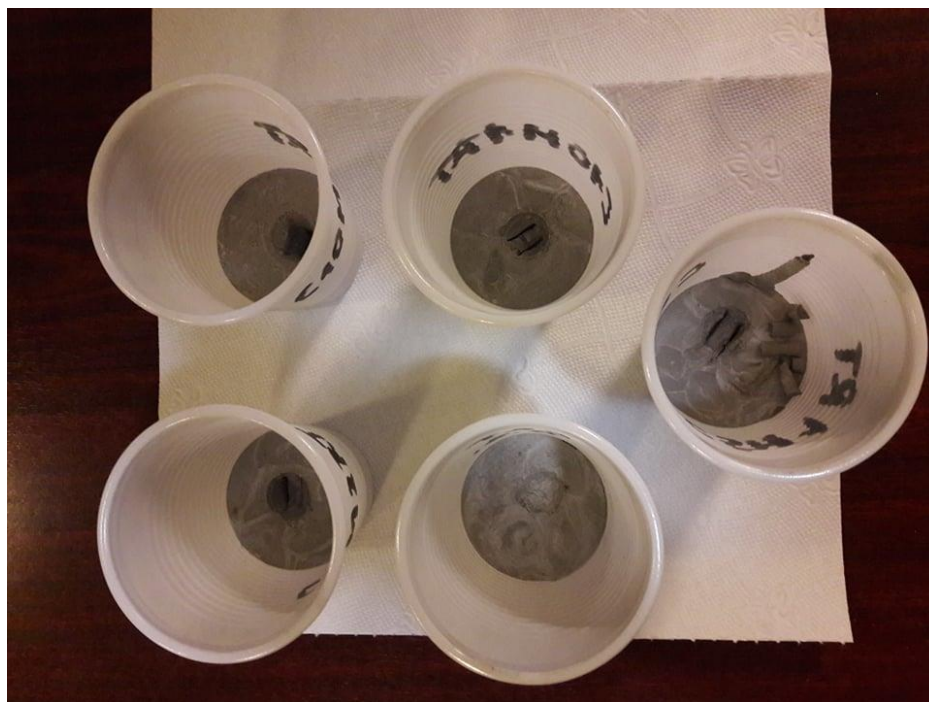
Slika 7. Uzorci cementne paste s različitim dodatkom MgO.
