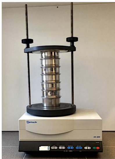
Slika 27. Aparatura za određivanje granulometrijske analize prosijavanjem.
