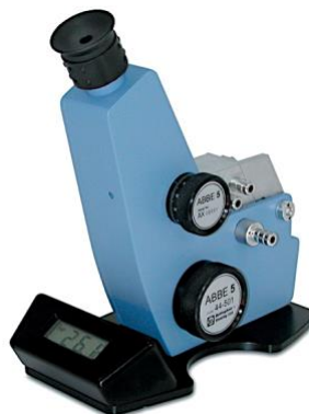
Slika 24. Bellingham & Stanley refraktometar.
