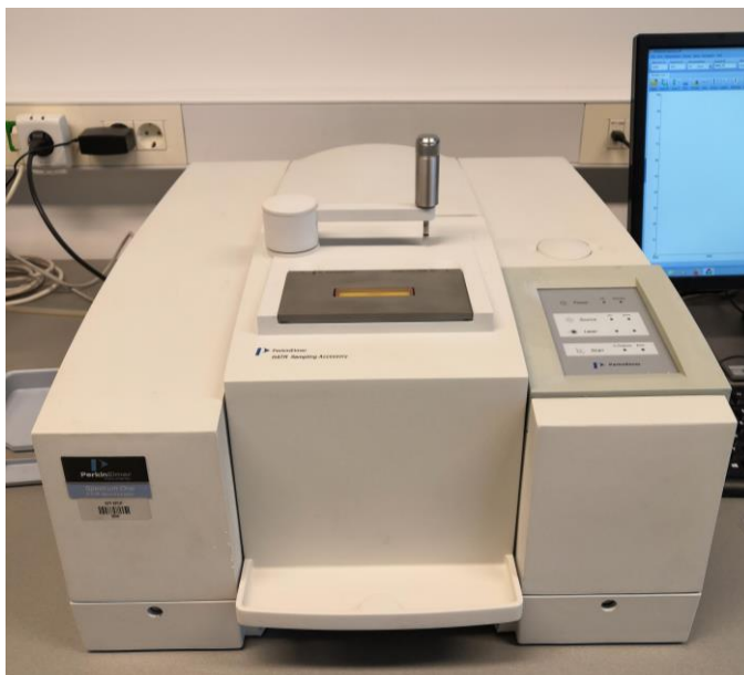
Slika 2.4. Perkin-Elmer IR spektrofotometar s HATR dodatkom.
