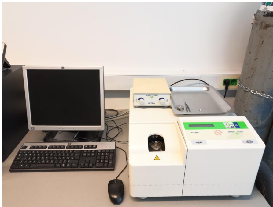
Slika 2.5. Diferencijalni pretražni kalorimetar Mettler-Toledo DSC 823 e .
