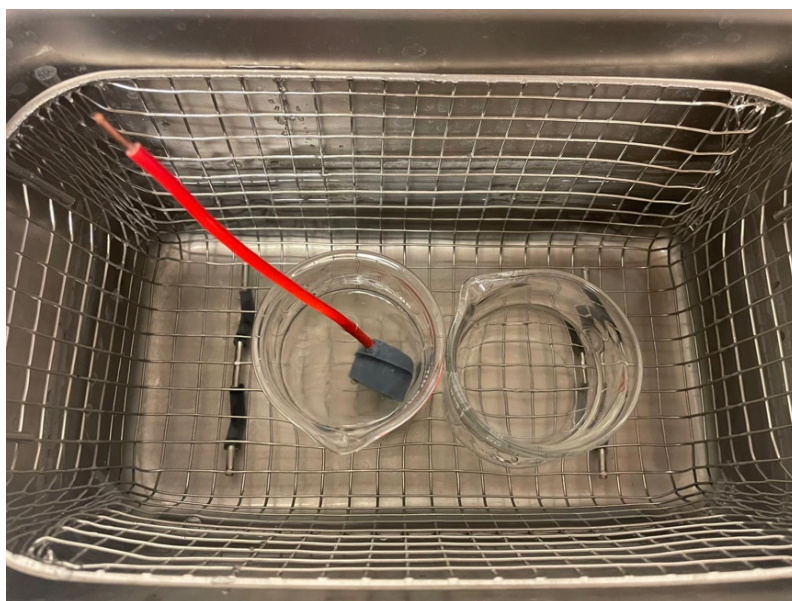
Slika 19. Čišćenje elektrode u ultrazvučnoj kupelji
