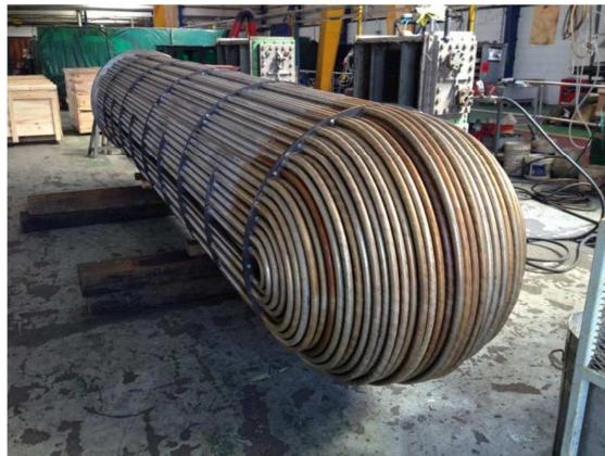
**Slika 7.** U-cijevni izmjenjivač<sup>12</sup>
