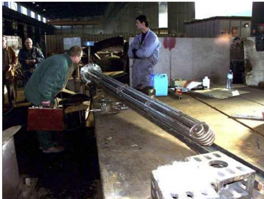
**Slika 8.** Izmjenjivač s plutajućom glavom<sup>10</sup>
