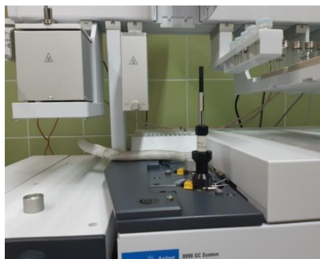
Slika 31. Desorpcija vršnih para
