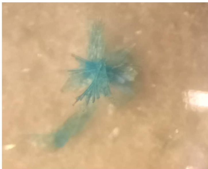
Slika 45. Prikaz bakrovih kristala s 6–hidroksinikotinskom kiselinom pod svjetlosnim mikroskopom pri pH=7
