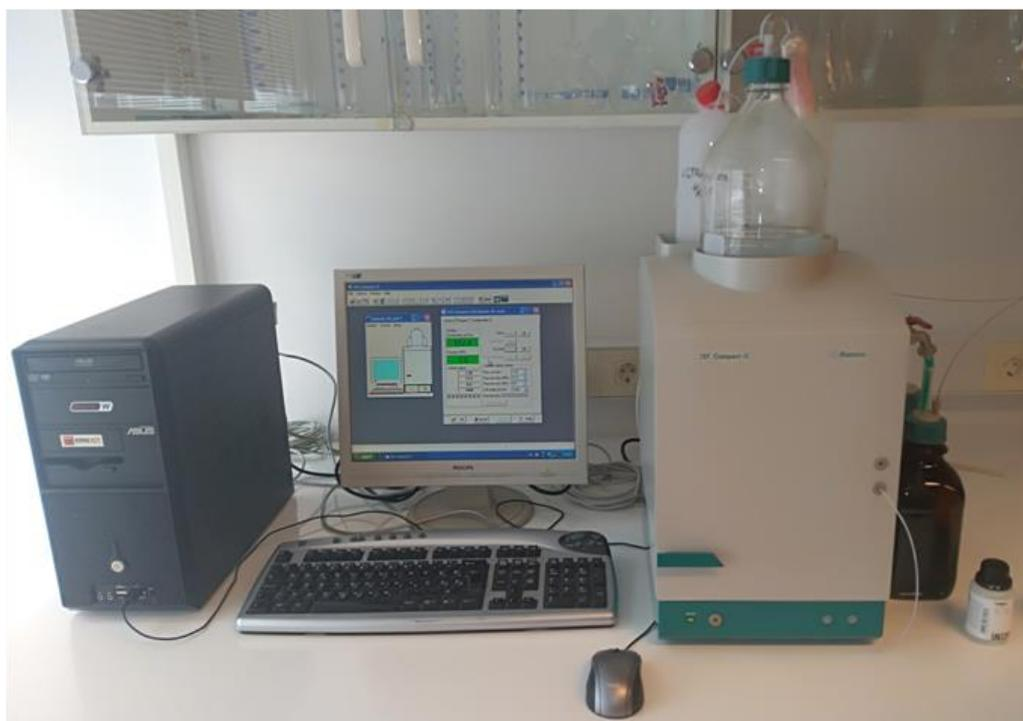
Slika 2.2. Ionski kromatograf Metrohm 761 Compact IC spojen na osobno računalo.<sup>38</sup>
