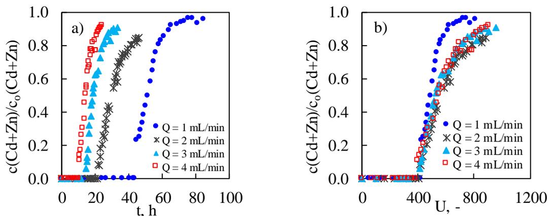
Slika 4.1. Krivulje proboja za ukupnu Cd+Zn koncentraciju u ovisnosti o: a) vremenu zadržavanja i b) broju volumena pora u sloju zeolita.<sup>38,41</sup>
