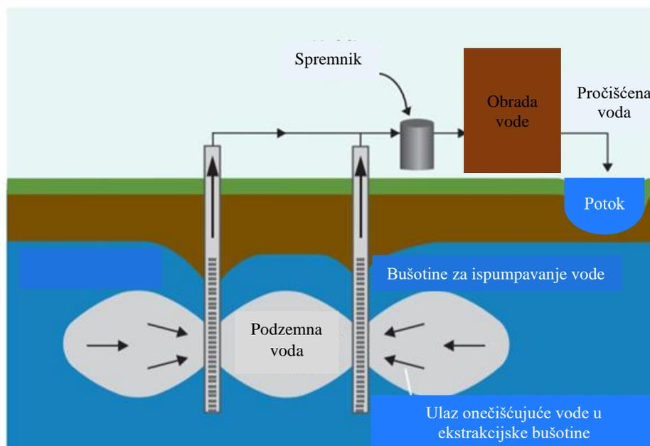
Slika 1.5. Primjer sustava pumpanja i tretiranja s dvije bušotine za vađenje.<sup>24</sup>
