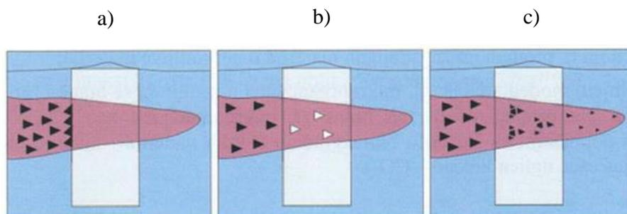
Slika 1.7. Shematski prikaz a) sorpcije, b) taloženja i c) razgradnje u propusnoj reaktivnoj barijeri.<sup>23</sup>
