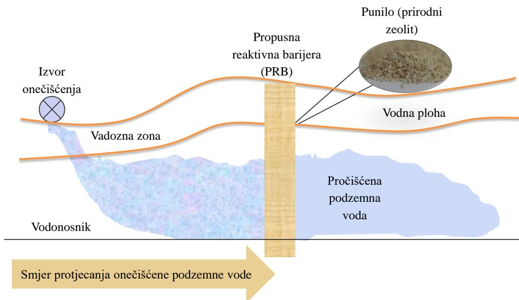
Slika 1.6. Shematski prikaz propusne reaktivne barijere.<sup>24,29</sup>
