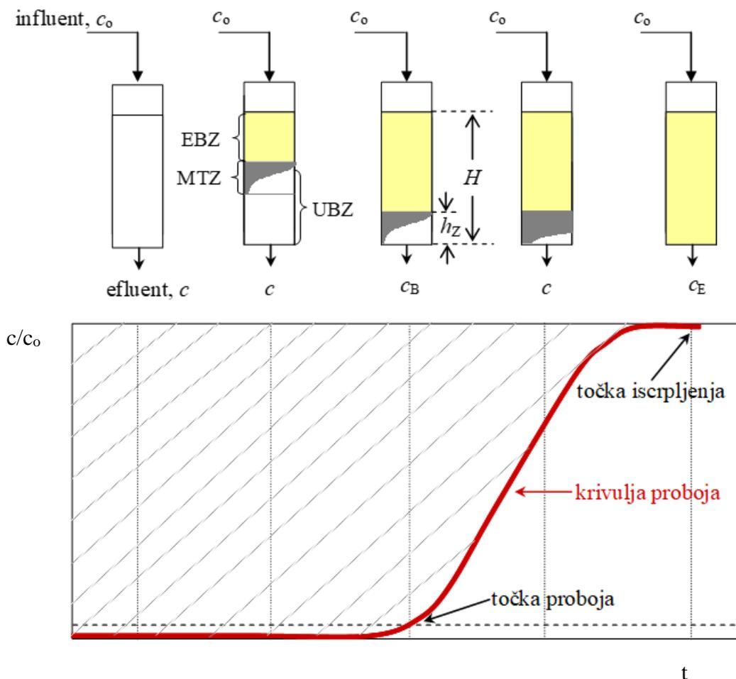
Slika 1.13. Shematski prikaz krivulje proboja i spuštanja MTZ u nepomičnom sloju zeolita.<sup>32</sup>
